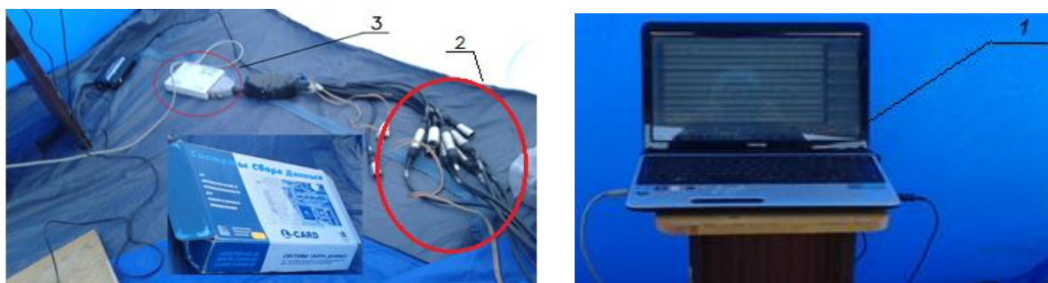
1 – портативный компьютер типа «NoteBook»; 2 – соединительный кабель со специальными разъемами; 3 – многоканальный АЦП E14-440.
